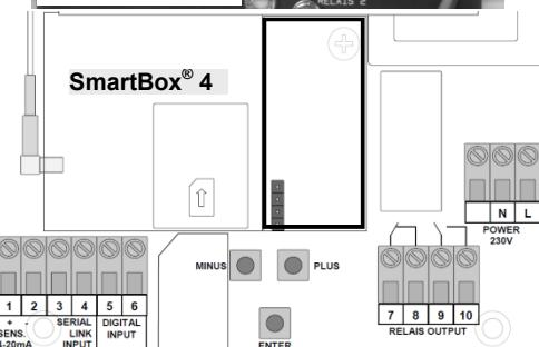
**Exemple de circuit du module enfichable DTM-4 - raccordement sur un système de gestion technique du bâtiment**
