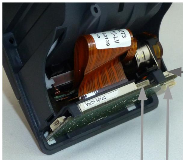
Abbildung 4: Controller-Platine GCT-43611 LV-Version
