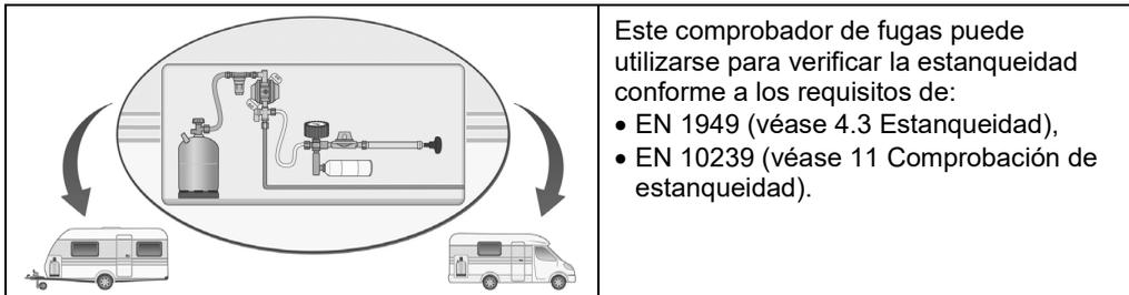
Este comprobador de fugas puede utilizarse para verificar la estanqueidad conforme a los requisitos de:
