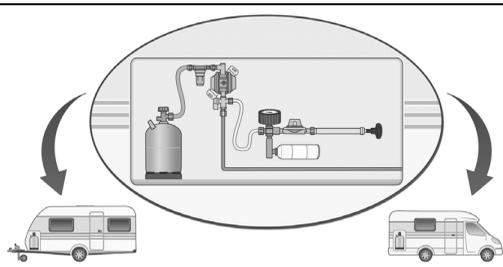
Cet appareil de contrôle permet de vérifier l'étanchéité, conformément aux exigences :
