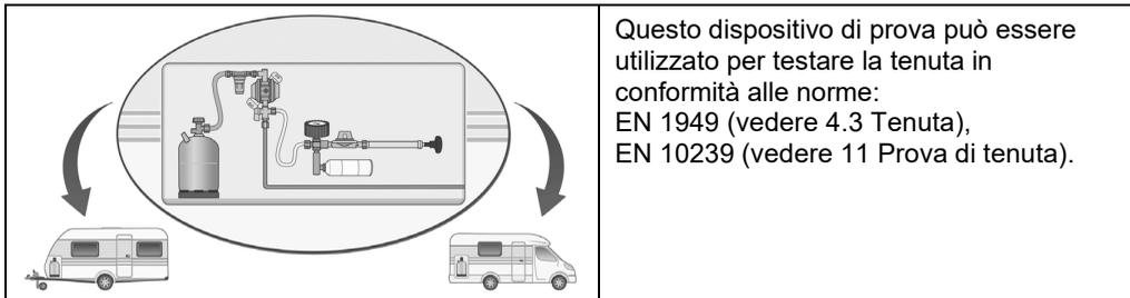
Questo dispositivo di prova può essere utilizzato per testare la tenuta in conformità alle norme:
