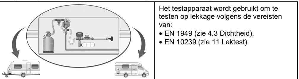
Het testapparaat wordt gebruikt om te testen op lekkage volgens de vereisten van:
