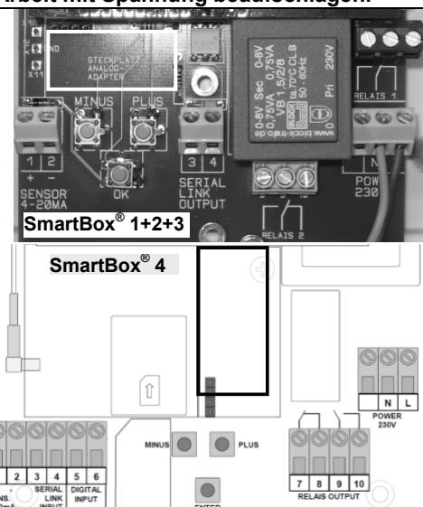
**Schaltungsbeispiel Steckmodul DTM-1 - Anschluss an ein Gebäudeleittechnik-System**
