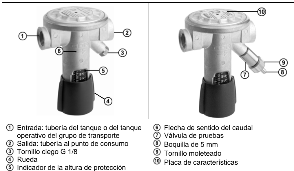
Figura 1: Estructura de los modelos con tornillo ciego o válvula de pruebas
