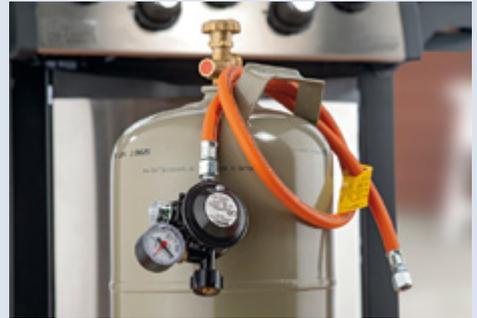
Druckregler und Schlauchleitung abmontieren
